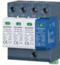
EP-GS-100/3+1 T1+T2+T3, Uc:320V,In:30kA, Imax:100kA. Iimp:8kA (3 Faz+N, B+C Sınıfı, 100 kA)
