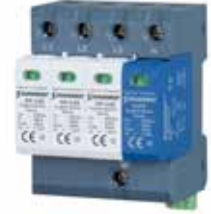
EP-C40/3+1 T2 Uc:275V,In:20kA, Imax:40kA (3 Faz+N, C Sınıfı, 40 kA)
