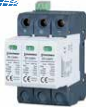
EP-C40PV 1500V T1+T2 Uc:1500V,In:20kA, Imax:40kA, Iimp:6.25kA (3 Faz 1500V DC, C Sınıfı, 40 kA)
